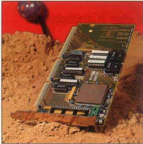
Seltene Gelegenheit, mal eine 80386-CPU aus der Nähe betrachten zu können. Beim IMC-Rechner befindet sich die CPU nicht auf dem Motherboard, sondern belegt eine Steckkarte — wozu auch immer das gut sein soll.
