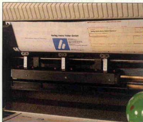
Gleich drei Druckköpfe erledigen beim Trimatrix den Druck einer Zeile.
